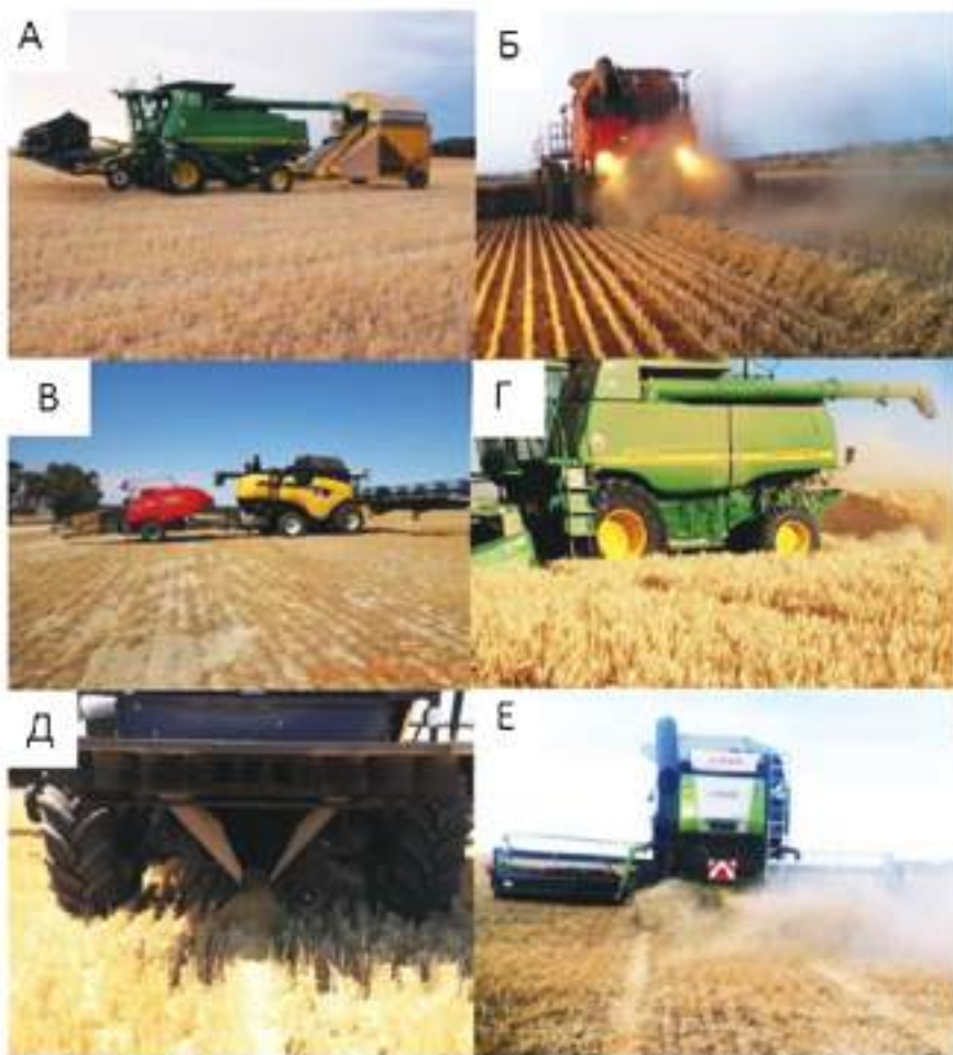
Рисунок 3. Современные формы борьбы с семенами сорняков (А) тележка для высевок, (Б) сжигание узкого валка, (В) прямая система тьюков, (Г) ударная мельница, (Д) выпрямление высевок и (Е) утрамбовка высевок.
