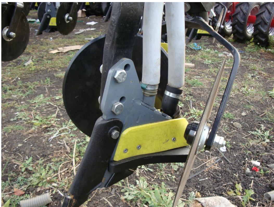
Рис. 10. Сошник Андерсона сеялки Norsh для прямого посева зерновых и зерно-бобовых культур.
