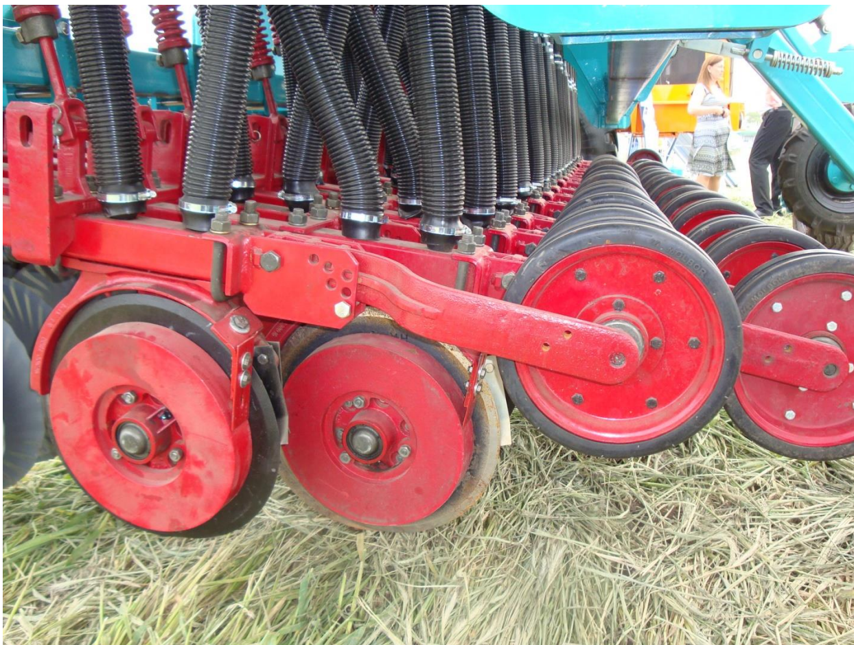
Рис. 11. Двухдисковый сошник со смещением
