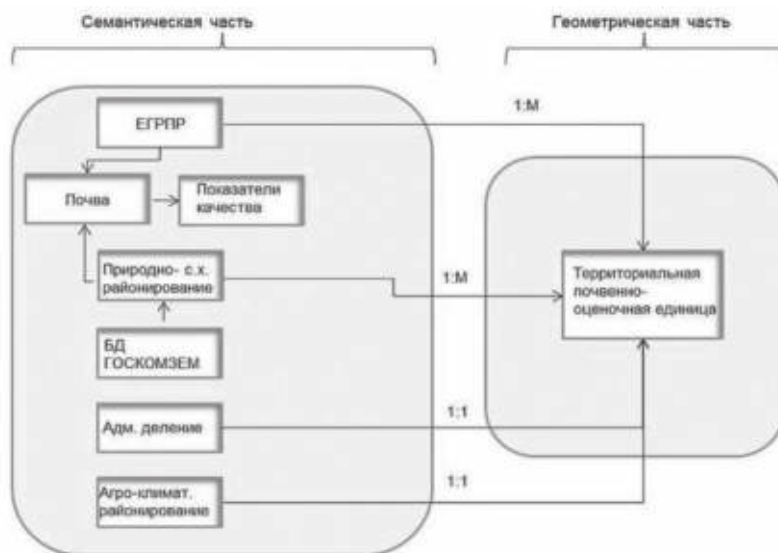
Рис. 2.1. Структура КПЗУР. Семантическая часть включает перечень и описание объектов (прямоугольники) и их взаимосвязей (стрелки). Геометрическая часть представлена полигонами объектов. Стрелки обозначают форму связи: 1:М — одна почва ЕГРПР может встречаться во многих территориальных почвенно-оценочных единицах; 1:1 означает, что только одна агроклиматическая провинция может быть в одной территориальной почвенно-оценочной единице.
